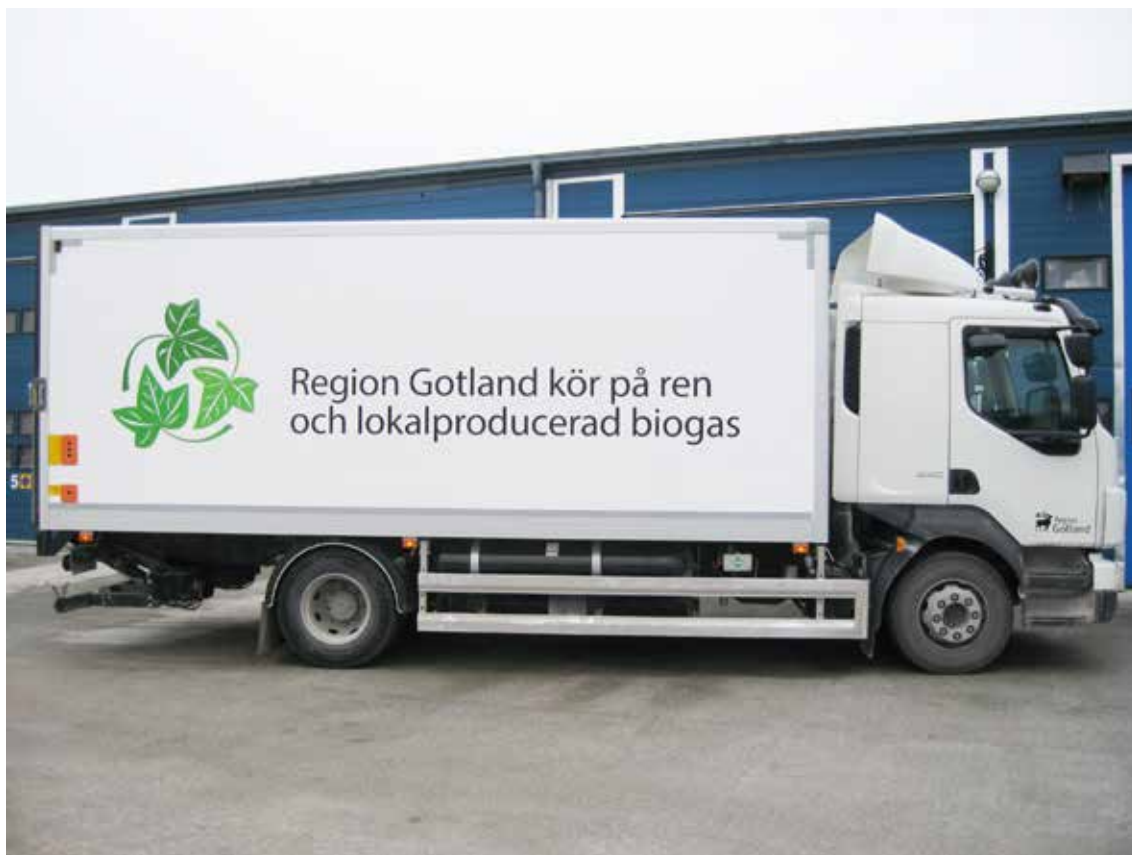
Serviceförvaltningens dualfuel (biogas + diesel) lastbil för varutransporter, i drift fr. o m 2014
